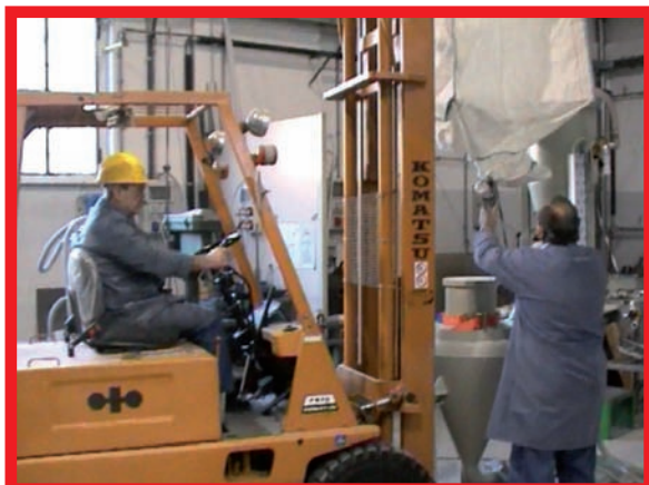
BIG BAG EMPTYING/TANK FILL
